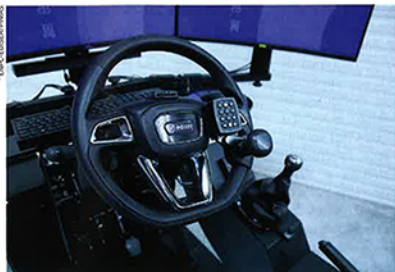
Différents accessoires peuvent être installés et enlevés en fonction du handicap du conducteur.
