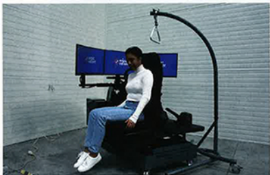
Le simulateur peut intégrer un siège pivotant et/ou une potence.
